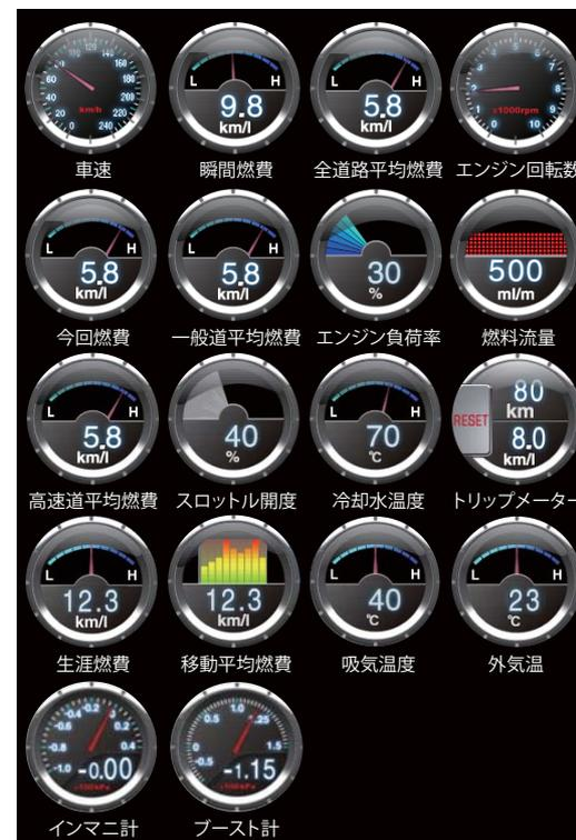
初期設定では、マルチメーターには「瞬間燃費」、「全道路平均燃費」、「トリップメーター」が表示されています。これを左図の18種類のメーターの中から選択し、表示を変更することができます。
