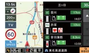
目的地までの走行ルートを確認することができます。ルートデモ中は、受信状況に「DEMO」と表示されます。画面左下には「SPEED」ボタンが表示され、走行スピードを3段階で調節できます。
