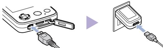
本機の端子カバーを開き、USB接続ケーブルを差し込みます。
