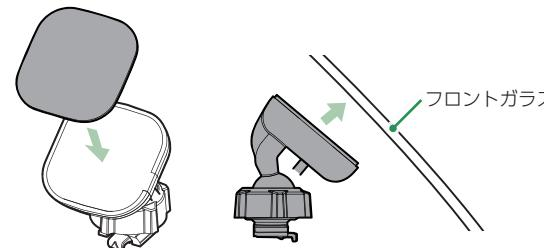
GPS内蔵ブラケットに本体を装着したときに、電源コードが接続でき、ボタン操作がしやすい場所に取り付けてください。
