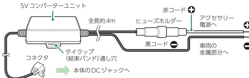
別売品の電源直結コードを本体のDCジャックと車両へ接続します。
