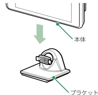
**1-3** 残りの保護フィルムをはがしダッシュボードの取り付け面に貼り付ける
