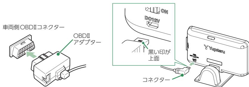
別売品のOBDIIアダプターを本体のDCジャックと車両のOBDIIコネクタに接続してください。
