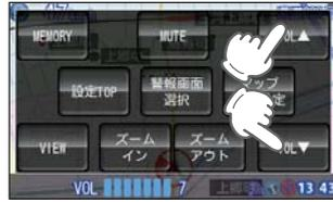
[VOL▲]、[VOL▼]にタッチで音量を調整できます。『ピッ』という確認音で音量を確認してください。
