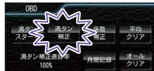
満タン補正進捗率が100になり「満タン補正」アイコンが点灯するまで走行してください。
