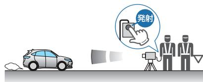
※ ステルス型取締り機は、計測する瞬間だけ電波を発射するため、受信できなったり、警報が間にあわない場合があります。また、取締りには電波を使用しない光電管式などもありますので、先頭を走行する際はくれぐれもご注意ください。
