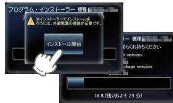
インストール完了後、右図画面になります。外部電源を外し、電池を取り出して電源OFFし、アップデート microSD カードを取り外してください。
