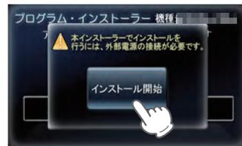
※内部電源で起動した場合は、右図画面になり、[インストール開始] 画面が表示されません。外部電源を接続してください。
