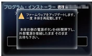
ファームウェアのアップデートが始まると右図画面になります。ファームウェアのアップデートが完了後、自動的に再起動します。
