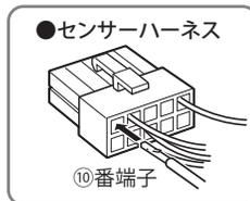
**2** ハザード制御：A-18SF(別売品)の+電源、アース線、ハザードランプ線を接続する
