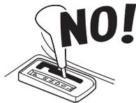
※ 一部の車両では、P・ポジション検出ができないものや、できにくいものがあります。このような場合には、フットブレーキまたはP・ポジションインジケータランプへの接続が必要です。接続しないと、本機は動作しません。フットブレーキに接続した場合は、フットブレーキを踏むとエンジンが停止します。またP・ポジションインジケータランプに接続した場合には、シフトレバーがパーキング(P)の位置以外ではエンジンを始動できません。
