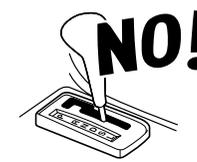
※ 一部の車輦では、パーキング(P)・ポジション検出のできないものや、できにくいものがあります。このような場合には、フットブレーキまたはPポジションインジケータランプへの接続が必要です。接続しないと、本機は動作しません。フットブレーキに接続した場合は、フットブレーキを踏むとエンジンが停止します。またPポジションインジケータランプに接続した場合には、シフトレバーがP(パーキング)の位置以外ではエンジンを始動できません。
