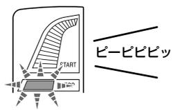
エンジン停止音『ピーピーピー』が鳴り、ストップマークが赤色で点滅します。
