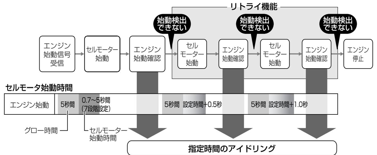
※ オルタネータ線を接続した場合、エンジンの始動を検出すると、セルモーターを停止します。
