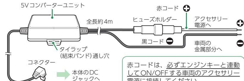
赤コードは、必ずエンジンキーと連動してON/OFFする車両のアクセサリー電源に接続してください。
