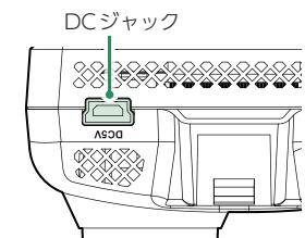
別売品の電源直結コードを本体のDCジャックと車両へ接続します。
