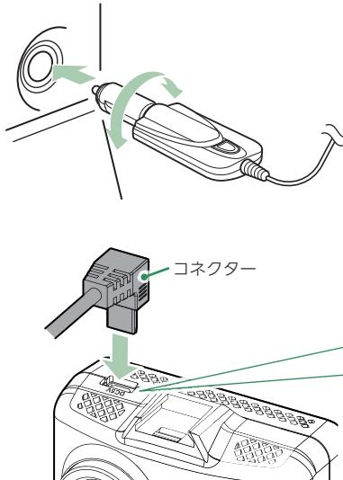
付属のシガープラグコードを本体のDCジャックと車両のシガーライター ソケットに挿し込みます。
