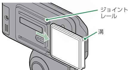
ブラケットの溝と本体のジョイントレールを合わせ、矢印の方向にスライドさせてください。
