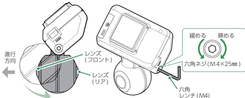
レンズ位置調整後は付属の六角レンチを使用して、位置がズレないようにレンズ部を押さえながら六角ネジを締めてください。
