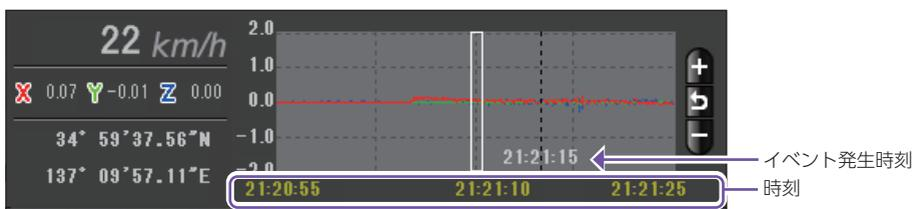
加速度センサーグラフは、記録したデータを加速度(縦軸)と時間(横軸)でグラフ表示します。
