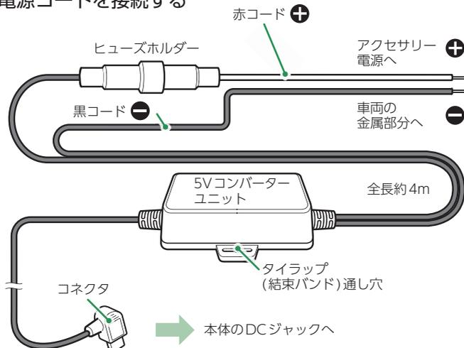
付属の電源直結コードを本体のDCジャックと車両へ接続します。
