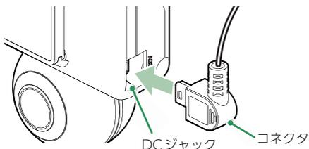
付属の電源直結コードを本体のDCジャックへ接続します。
