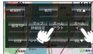
ジャンプウィンドウの [ズームアウト] (縮小)、[ズームイン] (拡大) にタッチで地図スケールを変更できます。
