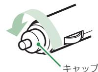
キャップを矢印の方向に回し、キャップを外します。
