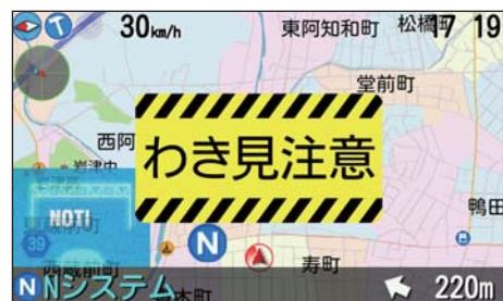
時速 30km/h 以上で運転中に約 3 秒以上わき見をしている場合に、警告します。
