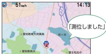
エンジンキーをONにし、本体の電源スイッチをONにしてください。必ず『測位しました』のボイスを確認してください。
