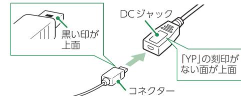
付属のシガープラグコードをアンテナユニットのDCジャックと車両のシガーライターソケットに接続します。
