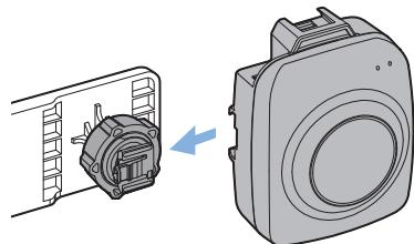
ルームミラー取り付け用ジョイントレールをスライドさせ取り付ける。
