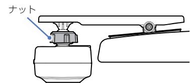
ナットを緩め、本機の向きを調整し、ナットを締めて固定します。
