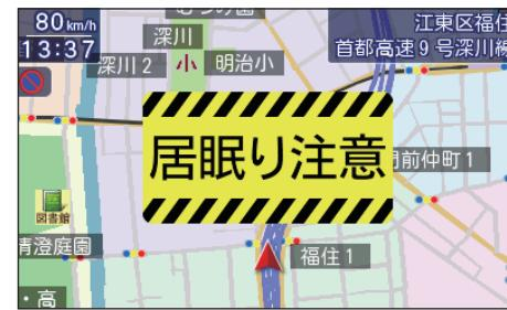
時速10km/h以上で運転中にまぶたを閉じている(両目を約1秒以上閉じている状態)場合に、警告します。
