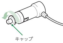
キャップを矢印の方向に回し、キャップを外します。
