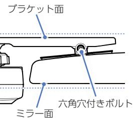
ルームミラーのミラー面と、ブラケットの面が平行になるように調整し、付属の六角レンチで六角穴つきボルトを締めて固定します。
