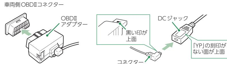
別売品のOBDIIアダプターをアンテナユニットのDCジャックと車両のOBDIIコネクターに接続してください。
