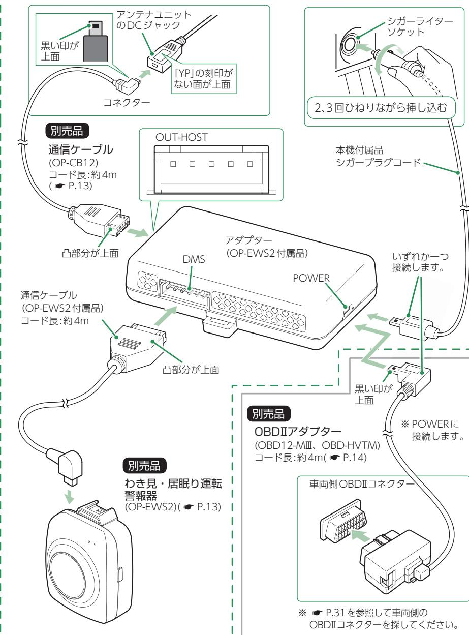
本機能は、顔の向きやまぶたの開閉を検出して各種危険を警告します。アダプターには、シガープラグコードかOBDIIアダプターのいずれかを使用します。
