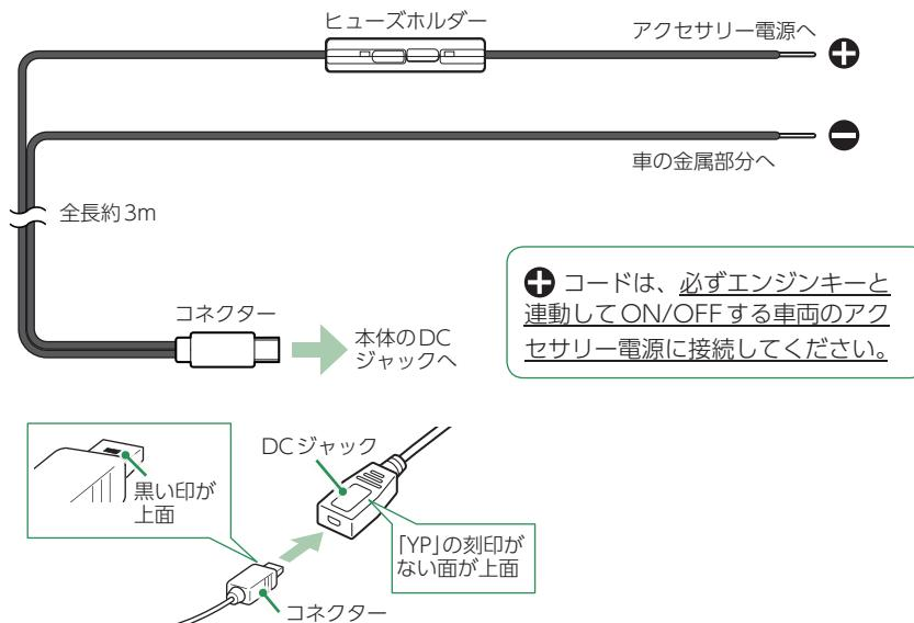
付属の電源直結コードをアンテナユニットのDCジャックと車両に接続します。
