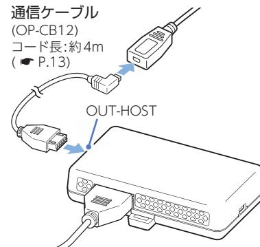
別売品の通信ケーブル(OP-CB12)をアダプターの[OUT-HOST]コネクターと、アンテナユニットのDCジャックに接続します。
