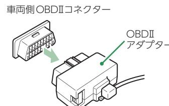
車両側OBDIIコネクター
