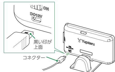
付属品のシガープラグコードを本体のDCジャックと車両のシガーライターソケットに接続します。
