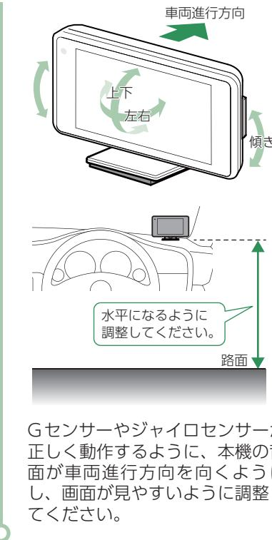
Gセンサー や ジャイロセンサーが正しく動作するように、本機の背面が車両進行方向を向くようにし、画面が見やすいように調整してください。
