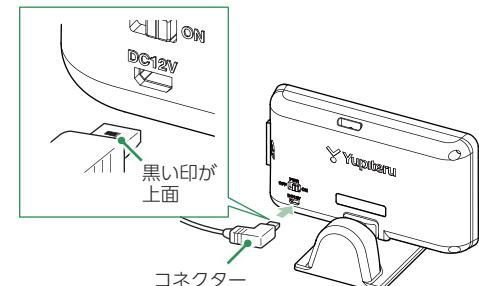
別売品のOBDIIアダプターを本体のDCジャックと車両のOBDIIコネクターに接続してください。
