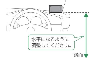
本体の背面を進行方向に向けて水平な路面と並行になるように取り付けてください。
