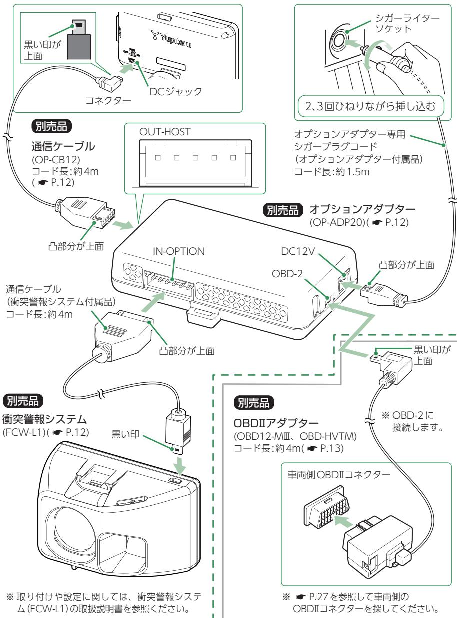
本機能は、赤外線レーザーを前方に照射し前の車からの反射により車間距離を測定することで前方車との接近、発進遅れを警告します。
