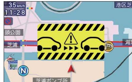
走行中に先行車両と自車の車間距離が短い場合に警告します。
