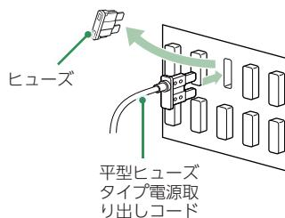
ヒューズの交換先は必ず、エンジンキーをACCの位置にした時に電圧が12V、OFFで0Vになるヒューズと交換してください。
