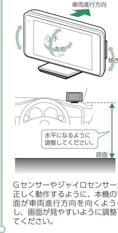
Gセンサー や ジャイロセンサーが正しく動作するように、本機の背面が車両進行方向を向くようにし、画面が見やすいように調整してください。
