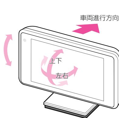
**7** Gセンサーやジャイロセンサーが正しく動作するように、本機の背面が車両進行方向を向くようにし、画面が見やすいように調整してください。
