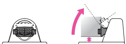
ダッシュボード取り付け用ブラケットは、アーム部の取り付け向きを180度変えることで、本機の取り付け高さを抑えることができます。
