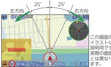
GPS警報は、ターゲットが進行方向に対して、右手または左手方向に約25°以上のとき、「左方向」または「右方向」のボイスを付加して、その方向をお知らせします。
