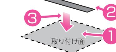
**1** ダッシュボードの取り付け面にホコリ、汚れや脂分がないことを確認してください。取り付け面は、なるべく平らで水平に近く、GPS電波を受信しやすい場所にしてください。
