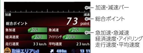
GPSの電波を受信して得られる速度データをもとに、「急加速のポイント」、「急減速のポイント」、「アイドリングのポイント」、「経済速度のポイント」の4項目から運転を総合評価します。また、現在の走行速度と、今回の平均速度も表示します。
