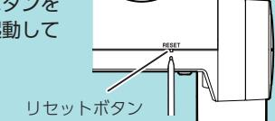
動作しなくなったり、誤作動を起こしたときは、本体下部のリセットボタンを押して、システムを再起動させてください。
