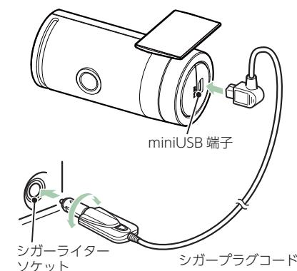
付属品のシガープラグコードを本機の miniUSB 端子と車両のシガーライターソケットに差し込みます。
