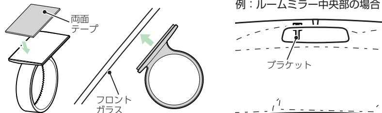
ブラケットに本体を装着したときに、シガープラグコードが接続でき、ボタン操作がしやすい場所に取り付けてください。
