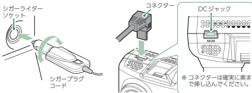
別売品のシガープラグコードをフロントカメラユニットのDCジャックと車両のシガーライターソケットに挿し込みます。
