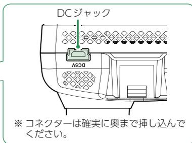
付属の電源直結コードをフロントカメラユニットのDCジャックへ接続します。
