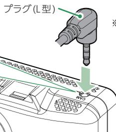
※ フロントカメラユニットにはプラグ(L型)をご使用ください。プラグ(ストレート型)を使用した場合、ケーブル接続時に負荷がかかり断線のおそれがあります。
