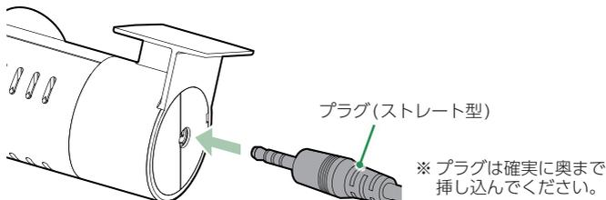
付属のリアカメラケーブルのプラグをリアカメラユニットのカメラジャックへ接続します。
