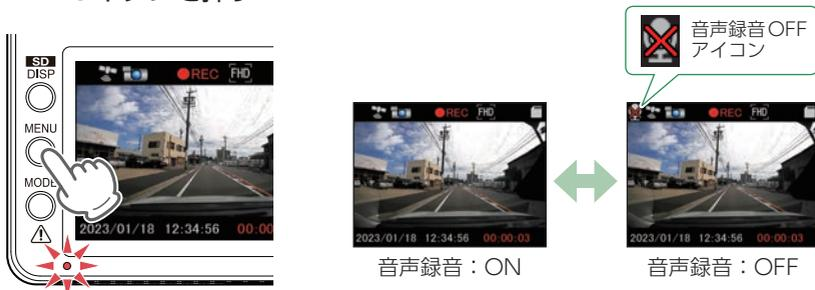
MENUボタンを押すたびに、音声録音のON/OFFが変更できます。
