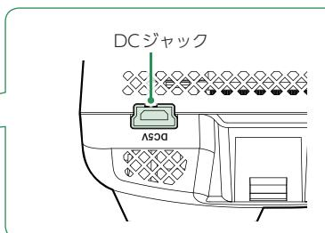
付属の電源直結コードを本体のDCジャックへ接続します。
