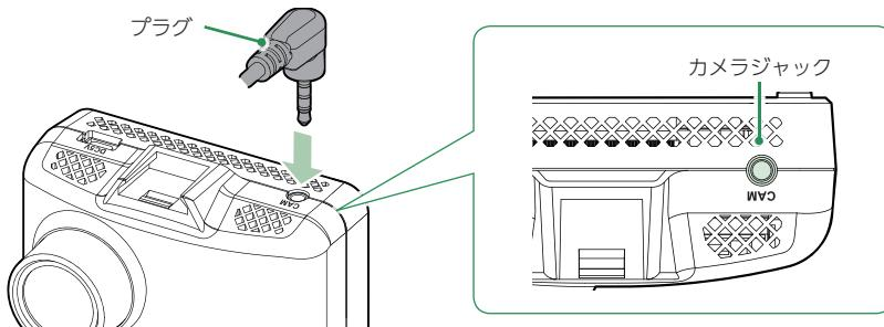
付属のリアカメラケーブルのプラグをフロントカメラユニットのカメラジャックへ接続します。
