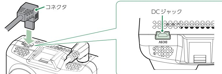
付属の電源直結コードを本体のDCジャックへ接続します。
