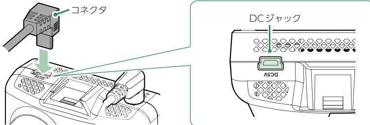
付属の電源直結コードをフロントカメラユニットのDCジャックと車両へ接続します。
