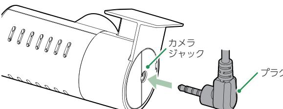
付属のリアカメラケーブルのプラグをリアカメラユニットのカメラジャックへ接続します。
