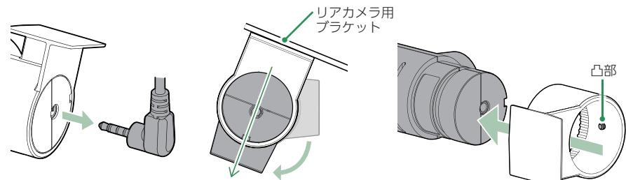
※リアカメラ用ブラケットには凸部があり、無理に引き抜こうとうすると破損の原因となります。必ず②の位置まで回してから取り外してください。
