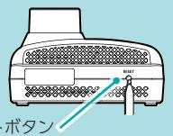
動作しなくなったり、誤作動を起こしたときは、本体下部のリセットボタンを押して、システムを再起動させてください。
