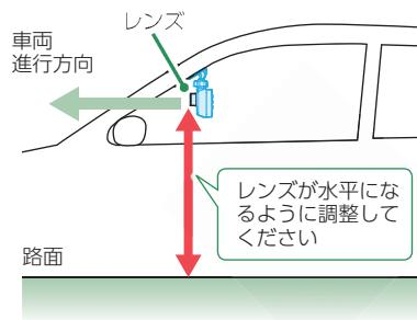
・Gセンサーの前後方向、左右方向、上下方向の数値は、レンズの向きが車両進行方向と水平の状態で固定されています。
