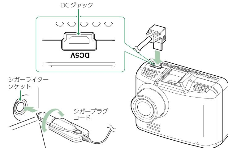
付属のシガープラグコードを本体のDCジャックと車両のシガーライター ソケットに差し込みます。
