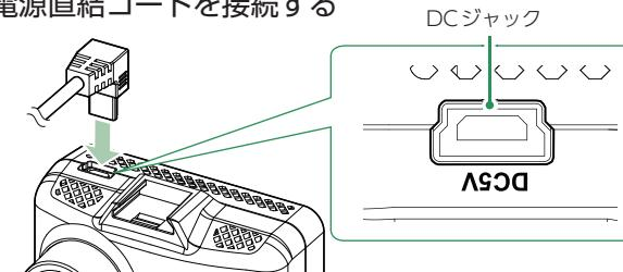
別売品の電源直結コード(OP-E863)を本体のDCジャックへ接続します。
