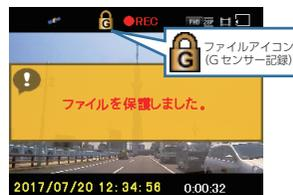
衝撃を検知すると、ファイルアイコンが点灯し、Gセンサー記録ファイルを生成します。
