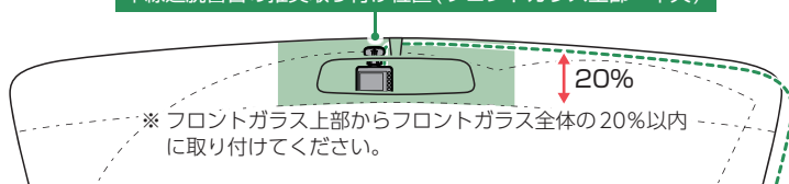
車線逸脱警告の推奨取り付け位置(フロントガラス上部・中央)
