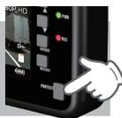
常時録画中に本機の PROTECT ボタンを押すことで、設定されたファイル単位の映像を microSD カードの「SWEVT」フォルダに、上書き禁止ファイルとして移動します。ファイルの録画時間は、設定内容によって異なります。
