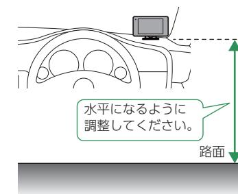
Gセンサーやジャイロセンサーが正しく動作するように、本機の背面が車両進行方向を向くようにし、画面が見やすいように調整してください。
