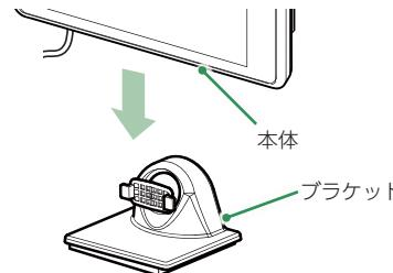
**1-3** 残りの保護フィルムをはがしダッシュボードの取り付け面に貼り付ける
