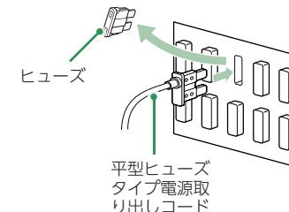
ヒューズの交換先は必ず、エンジンキーをACCの位置にした時に電圧が12V、OFFで0Vになるヒューズと交換してください。
