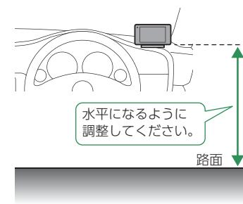
本体の背面を進行方向に向けて水平な路面と並行になるように取り付けてください。
