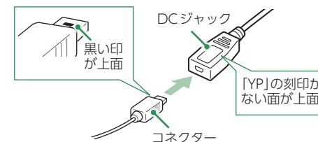
付属の電源直結コードをアンテナのDCジャックと市販品の平型ヒューズタイプ電源取り出しコードに接続します。
