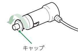
キャップを矢印の方向に回し、キャップを外します。
