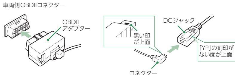
別売品のOBDIIアダプターをアンテナのDCジャックと車両のOBDIIコネクターに接続してください。
