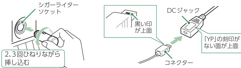
付属のシガープラグコードをアンテナのDCジャックと車両のシガーライター ソケットに接続します。
