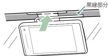
ステーをフロントガラスの天井の隙間に差し込み、黒縁部分に両面テープを押し当てながら貼り付けてください。
