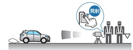
※ ステルス型取締り機は、計測する瞬間だけ電波を発射するため、受信できなかったり、警報が間にあわない場合があります。また、取締りには電波を使用しない光電管式などもありますので、先頭を走行する際はくれぐれもご注意ください。
