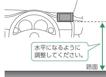
本体の背面を進行方向に向けて水平な路面と並行になるように取り付けてください。
