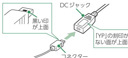
電源直結コードをアンテナのDCジャックと市販品の平型ヒューズタイプ電源取り出しコードに接続します。
