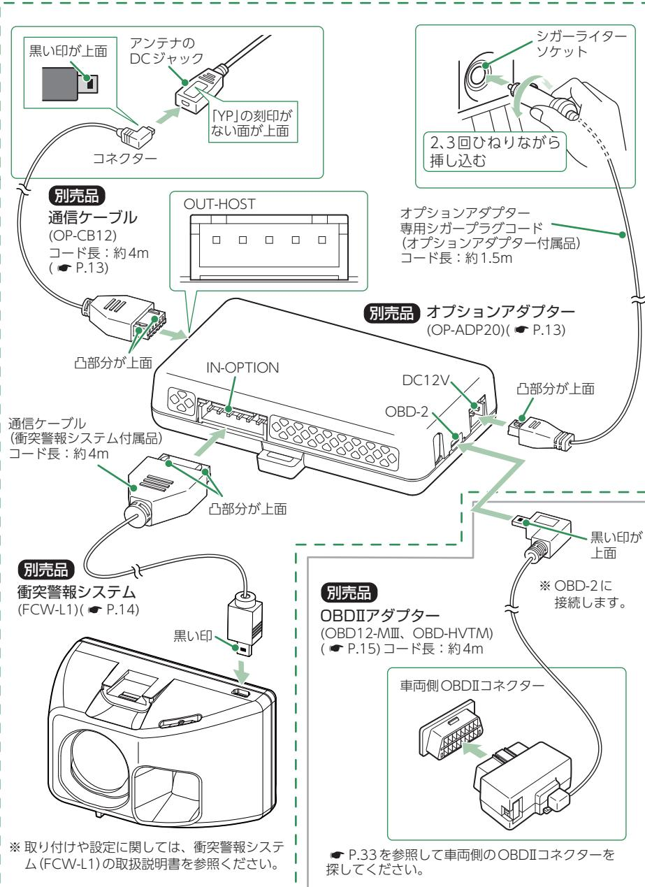
衝突警報システム (FCW-L1) を接続する場合に、オプションアダプター (OP-ADP20) が必要です。オプションアダプターには、OBD端子があり、OBDIIアダプターと同時に使用できます。
