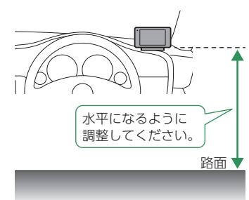
本体の背面を進行方向に向けて水平な路面と並行になるように取り付けてください。
