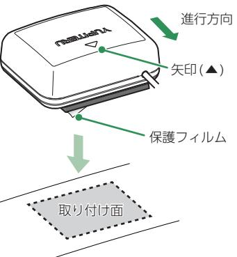
アンテナが道路に対して水平に、また矢印(▲)を進行方向(前方)に向け、GPS電波が受信しやすい場所に取り付けてください。
