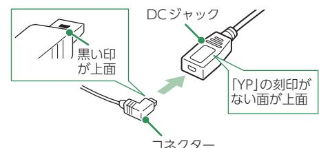
別売品のOBDIIアダプターをアンテナのDCジャックと車両のOBDIIコネクターに接続してください。
