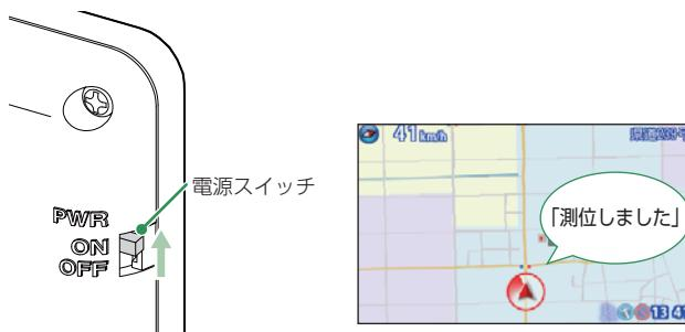
エンジンキーをONにし、本体の電源スイッチをONにしてください。
