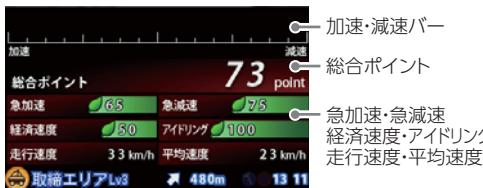
GPSの電波を受信して得られる速度データをもとに、「急加速のポイント」、「急減速のポイント」、「アイドリングのポイント」、「経済速度のポイント」の4項目から運転を総合評価します。また、現在の走行速度と、今回の平均速度も表示します。
