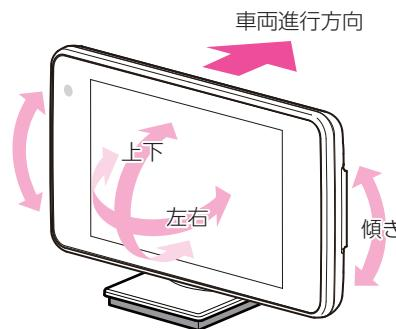
**7** Gセンサーやジャイロセンサーが正しく動作するように、本機の背面が車両進行方向を向くようにし、画面が見やすいように調整する
