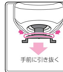
アーム部のツバの部分を布などで保護し、手前に引き抜きます。ラジオペンチなどを使用すると、簡単に抜けます。爪部を掴むと爪が折れる場合があります。
