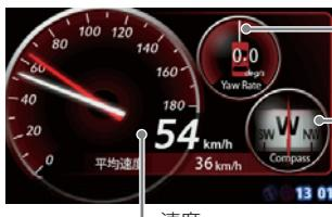
ヨーレート 車両の旋回方向の角速度を表示します。
