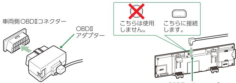
別売品のOBDIIアダプターを本体のOBDIIコネクタージャックと車両のOBDIIコネクターに接続してください。
