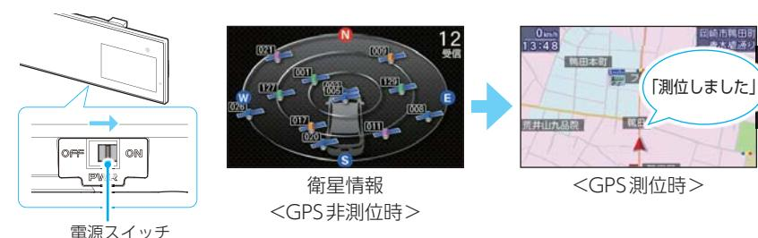
エンジンキーをONにし、本体の電源スイッチをONにしてください。
