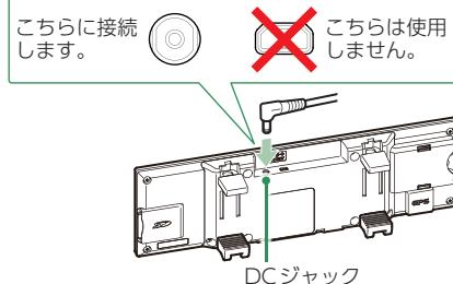
付属の電源直結コードを本体のDCジャックと市販品の平型ヒューズタイプ電源取り出しコードに接続します。
