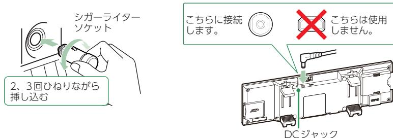
付属のシガープラグコードを本体のDCジャックと車両のシガーライターソケットに接続します。
