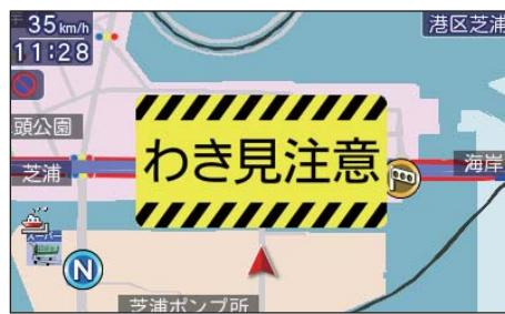
時速30km/h以上で運転中に約3秒以上わき見をしている場合に、警告します。
