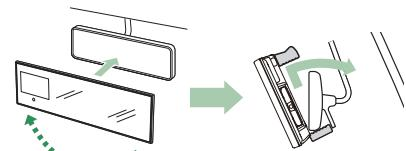
上下を逆さまに（反転）させると、表示部も自動で上下反転します。[自動反転機能]
