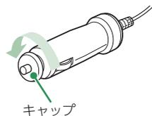
キャップを矢印の方向に回し、キャップを外します。
