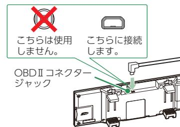
別売品のOBDIIアダプターを本体のOBDIIコネクタージャックと車両のOBDIIコネクターに接続してください。
