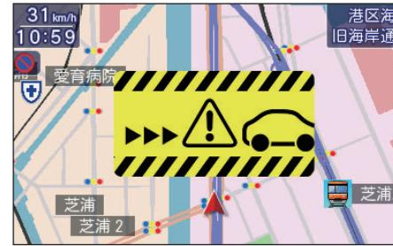
停止している先行車両に接近した場合に、警告します。
