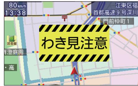
時速10km/h以上で運転中に約3秒以上わき見をしている場合に、警告します。
