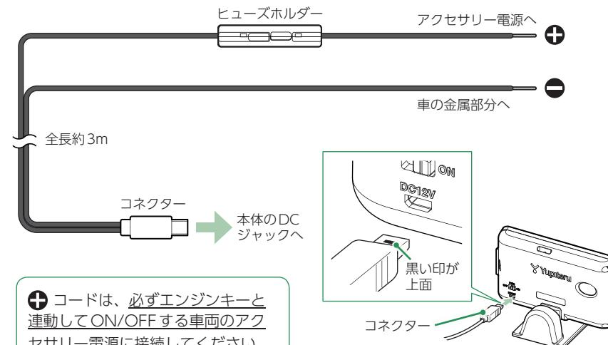
別売品の電源直結コードを本体のDCジャックと車両に接続します。
