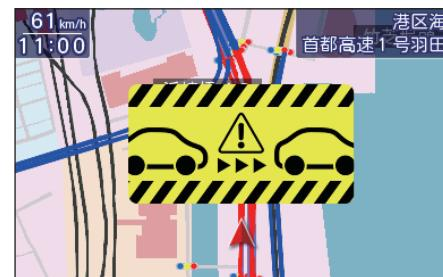
走行中に先行車両と自車の車間距離が短い場合に警告します。
