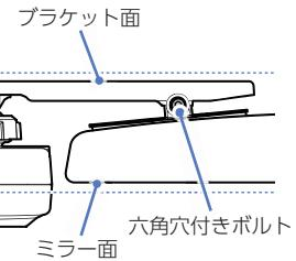
ルームミラーのミラー面と、ブラケットの面が平行になるように調整し、付属の六角レンチで六角穴つきボルトを締めて固定します。
