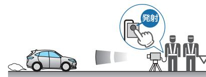
※ ステルス型取締機は、計測する瞬間だけ電波を発射するため、受信できなかったり、警報が間にあわない場合があります。また、取締には電波を使用しない光電管式などもありますので、先頭を走行する際はくれぐれもご注意ください。
