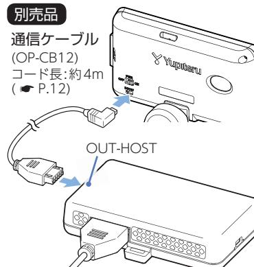
別売品の通信ケーブル(OP-CB12)をアダプターの[OUT-HOST]コネクターと、レーダー探知機のDCジャックに接続します。
