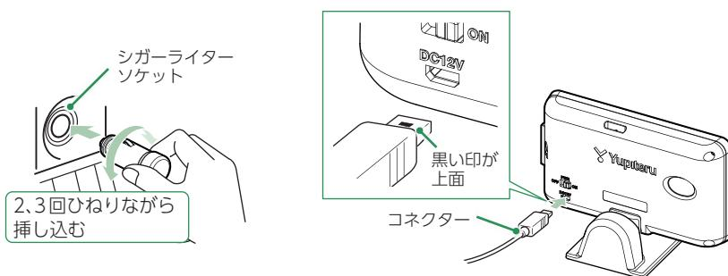
付属のシガープラグコードを本体のDCジャックと車両のシガーライターソケットに接続します。
