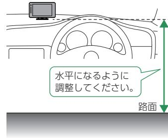
本機の背面を進行方向に向けて水平な路面と並行になるように取り付けてください。
