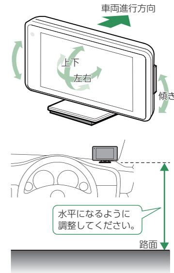
Gセンサーやジャイロセンサーが正しく動作するように、本機の背面が車両進行方向を向くようにし、画面が見やすいように調整してください。
