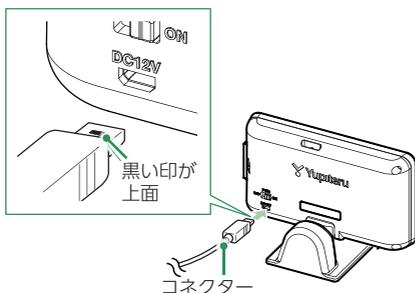
電源直結コードを本体のDCジャックと市販品の平型ヒューズタイプ電源取り出しコードに接続します。
