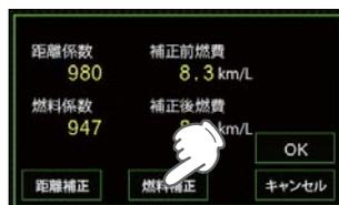
3-6 燃料補正を入力し[OK]にタッチする
