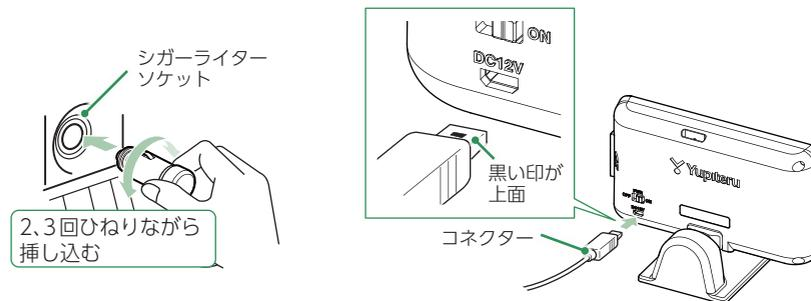
付属品のシガープラグコードを本体のDCジャックと車両のシガーライターソケットに接続します。
