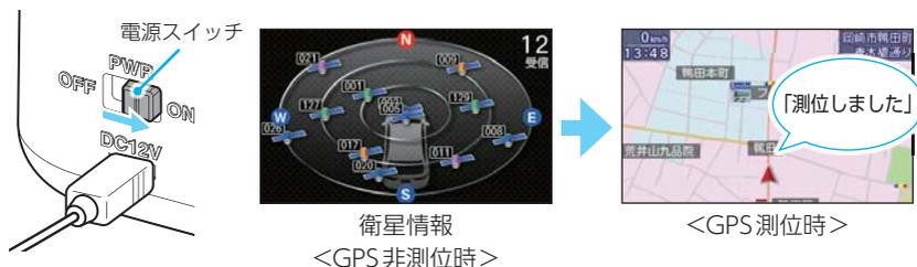
エンジンキーをONにし、本体の電源スイッチをONにしてください。
