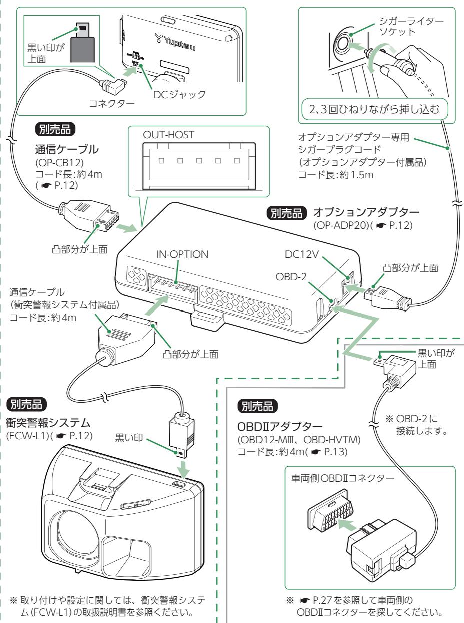
本機能は、赤外線レーザーを前方に照射し前の車からの反射により車間距離を測定することで前方車との接近、発進遅れを警告します。衝突警報システム (FCW-L1) を接続する場合には、オプションアダプター (OP-ADP20) が必要です。オプションアダプターには、OBD端子があり、OBDIIアダプターと同時に使用できます。
