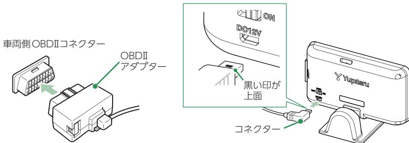
別売品のOBDIIアダプターを本体のDCジャックと車両のOBDIIコネクターに接続してください。
