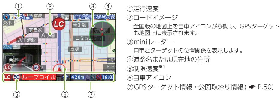
\*1 : 制限速度表示は、オービス(ループコイル／LHシステム／新Hシステム／レーダー式オービス)と一部の取締エリア警報時に表示します。
