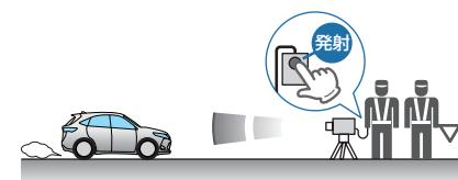
※ ステルス型取締り機は、計測する瞬間だけ電波を発射するため、受信できなかったり、警報が間にあわない場合があります。また、取締りには電波を使用しない光電管式などもありますので、先頭を走行する際はくれぐれもご注意ください。
