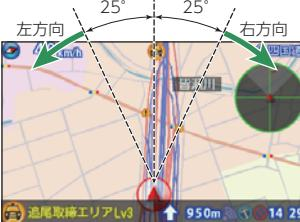
GPS警報は、ターゲットが進行方向に対して、右手または左手方向に約25°以上のとき、「左方向」または「右方向」のボイスを付加して、その方向をお知らせします。
