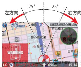
GPS警報は、ターゲットが進行方向に対して、右手または左手方向に約25°以上のとき、「左方向」または「右方向」のボイスを付加して、その方向をお知らせします。
