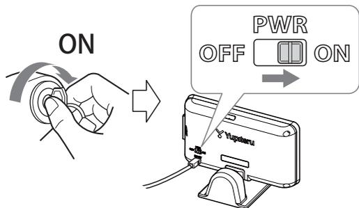
**1** エンジンキーをONにし、本機の電源スイッチを『ON』にしてください。
