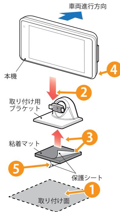
**1** ダッシュボードの取り付け面にホコリや汚れがないことを確認してください。取り付け面は、なるべく平らで水平に近く、GPS電波を受信しやすい場所にしてください。
