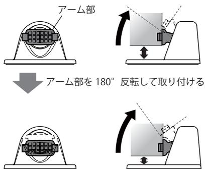
ダッシュボード取り付け用ブラケットは、アーム部の取り付け向きを180度変えることで、本機の実取り付け高さを抑えることができます。
