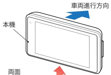
**1** ダッシュボードの取り付け面にホコリ、汚れや脂分がないことを確認してください。取り付け面は、なるべく平らで水平に近く、GPS電波を受信しやすい場所にしてください。
