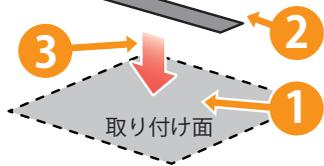
**3** 直付け用両面テープの残った保護シートを剥がしてください。本機の背面を車両進行方向に向けて、水平な路面と平行になるように取り付けてください。取り付けをしたあと、剥がすと粘着力が落ちます。再度取り付ける場合は、同等の両面テープ(市販品)をご用意ください。
