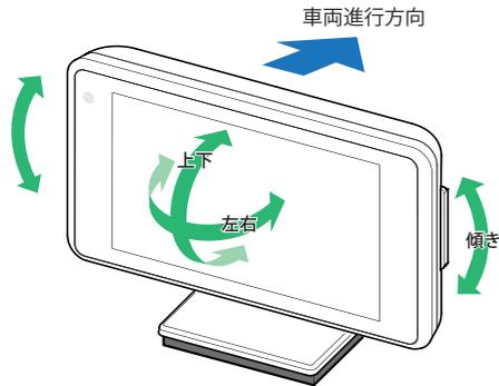
**7** Gセンサーやジャイロセンサーが正しく動作するように、本機の背面が車両進行方向を向くようにし、画面が見やすいように調整してください。
