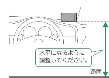
本体の背面を進行方向に向けて水平な路面と並行になるように取り付けてください。
