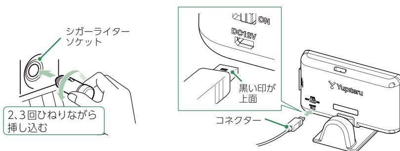
付属品のシガープラグコードを本体のDCジャックと車両のシガーライターソケットに接続します。
