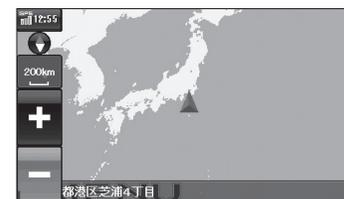
地図スケールは、10m、25m、50m、100m、200m、500m、1.0km、2.5km、5.0km、10km、20km、50km、100km、200kmの14段階に切り替わります。
