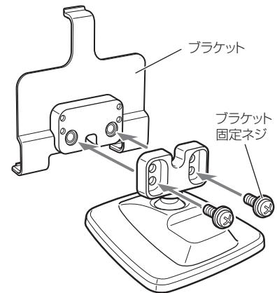
本機は、自由自在な角度調整が行えるボールジョイント方式のブラケットを採用しています。また、国土交通省の保安基準改正によるフロントガラスの取り付け規制に伴い、新素材の粘着マットを採用し、ダッシュボードへの取り付けをスマートにしました。
