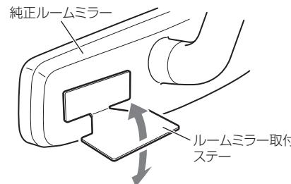
※ ルームミラー取付ステーを折り曲げるときは、アンテナを取り付けない状態で折り曲げてください。アンテナを取り付けた状態で折り曲げると、アンテナの破損の原因となります。
