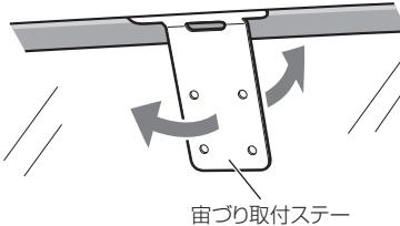
※宙づり取付ステーを折り曲げるときは、いったん、表示部とブラケットを外した状態で折り曲げてください。表示部とブラケットを取り付けた状態で折り曲げると、表示部やブラケットの破損の原因となります。
