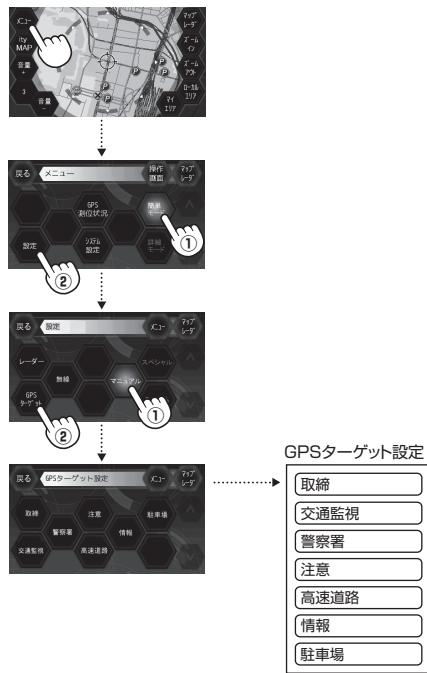
GPSターゲット設定・道路識別設定のフローチャート（詳細モード：ローカル・ドライブ）
