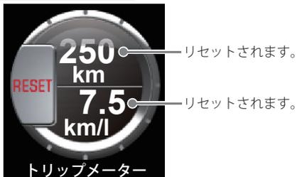
マルチメーターの中で選択できるトリップメーターの積算距離と燃費計をリセットできます。
