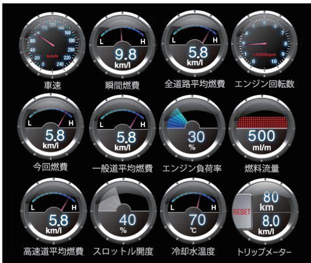
初期設定では、マルチメーターには「瞬間燃費」、「全道路平均燃費」、「トリップメーター」が表示されています。これを左図の12種類のメーターの中から選択し、表示を変更することができます。「瞬間燃費」、「今回燃費」、「全道路平均燃費」、「一般道平均燃費」、「高速道平均燃費」、「冷却水温度計」のメーターは、上段にアナログ表示、下段にデジタル表示が連動して表示されます。
