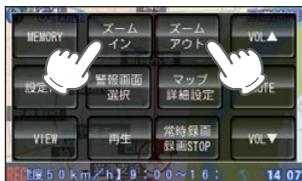
ジャンプウィンドウの[ズームイン](拡大)、[ズームアウト](縮小)にタッチで地図スケールを変更できます。
