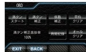
満タン補正進捗率が100%になり「満タン補正」アイコンが点灯するまで走行してください。
