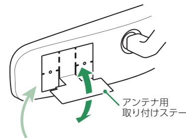
あらかじめ純正ルームミラーの角度と貼り付け場所を決めておき、アンテナができるだけ道路に対して水平になるようステーを折り曲げて、角度の調整をしてください。
