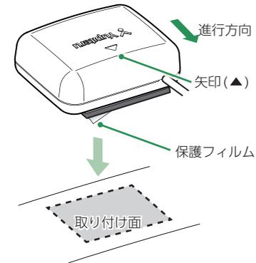
アンテナが道路に対して水平に、また矢印(▲)を進行方向(前方)に向け、GPS電波が受信しやすい場所に取り付けてください。
