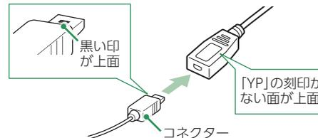
付属の電源直結コードをアンテナのDCジャックと市販品の平型ヒューズタイプ電源取り出しコードに接続します。
