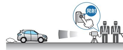
※ ステルス型取締機は、計測する瞬間だけ電波を発射するため、受信できなかったり、警報が間にあわない場合があります。また、取締りには電波を使用しない光電管式などもありますので、先頭を走行する際はくれぐれもご注意ください。
