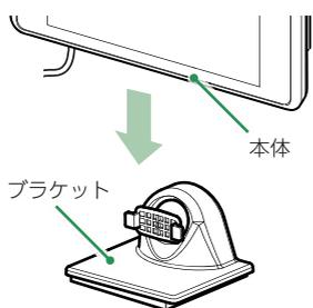
**1-3** 残りの保護フィルムをはがし、ダッシュボードの取り付け面に貼り付ける
