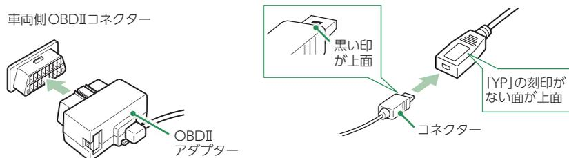
別売品のOBDIIアダプターをアンテナのDCジャックと車両のOBDIIコネクタに接続してください。
