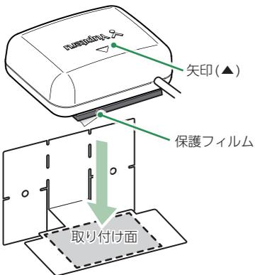
ステーを純正ルームミラーに取り付けた時に、アンテナの矢印(▲)が進行方向(前方)に向くように貼り付けてください。
