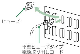
ヒューズの交換先は必ず、エンジンキーをACCの位置にした時に電圧が12V、OFFで0Vになるヒューズと交換してください。
