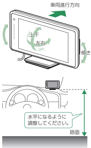
Gセンサーやジャイロセンサーが正しく動作するように、本機の背面が車両進行方向を向くようにし、画面が見やすいように調整してください。
