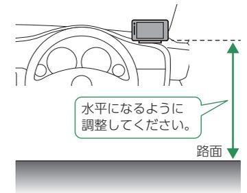
本体の背面を進行方向に向けて水平な路面と並行になるように取り付けてください。
