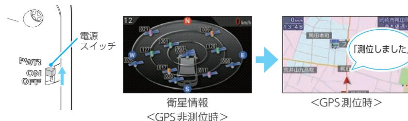
エンジンキーをONにし、本体の電源スイッチをONにしてください。必ず『測位しました』のボイスを確認してから走行してください。
