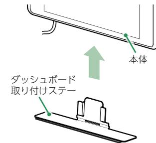
3-3 残りの保護フィルムをはがし、ダッシュボードの取り付け面に貼り付ける
