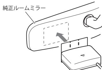
**1** あらかじめ純正ルームミラーの角度と張付場所を決めておき、アンテナができるだけ道路に対して水平になるようアンテナ用取付けステーを折り曲げて、角度の調整をする
