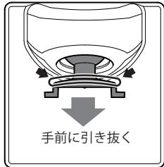
アーム部のツバの部分を布などで保護し、手前に引き抜きます。ラジオペンチなどを使用すると、簡単に抜けます。爪部を掴むと爪が折れる場合があります。
