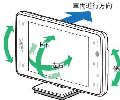
**7** Gセンサーやジャイロセンサーが正しく動作するように、本機の背面が車両進行方向を向くようにし、画面が見やすいように調整してください。
