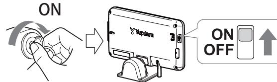
**1** エンジンキーをONにし、本機の電源スイッチを『ON』してください。
