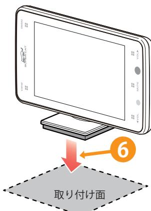
**6** ダッシュボードの取り付け面に取り付けます。
