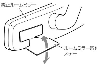
※ ルームミラー取付ステーを折り曲げるときは、アンテナを取り付けない状態で折り曲げてください。アンテナを取り付けた状態で折り曲げると、アンテナの破損の原因となります。
