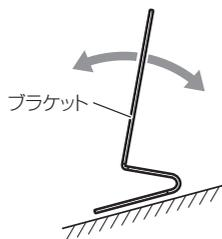
※ ブラケットを折り曲げるときは、一旦、表示部からはずして調整してください。そのまま折り曲げると、本体の破損の原因となります。
