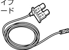
必ず、エンジンキーのACC ON/OFF操作と連動してON/OFFする回路(カーラジオなど)のヒューズと差し替えてください。
