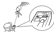
GPS(Global Positioning System)とは、衛星軌道上の人工衛星から発信される電波により、緯度・経度を測定するシステムです。
