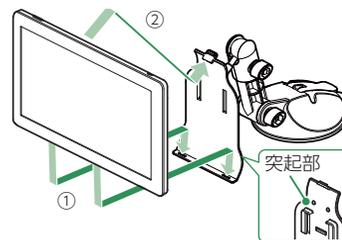
本体の溝をブラケット下部の爪に合わせてセットし、『カチッ』というまで、ブラケット背面の突起物を押ししてください。
