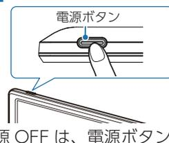
電源 OFF は、電源ボタンを押すか、車両のエンジンを OFF してください。
