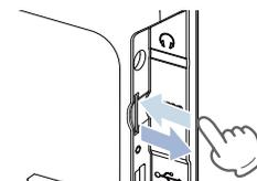
SD カードを押し込み、カードが少し飛び出してから引き抜いてください。
