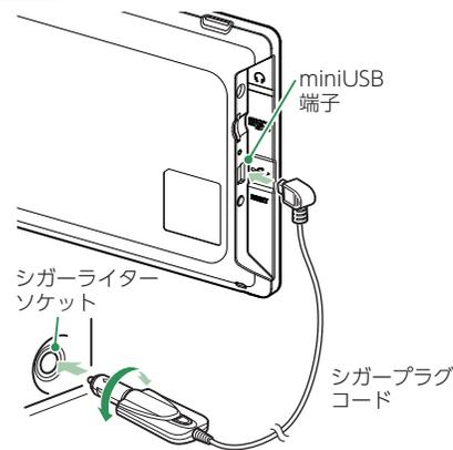
付属品のシガープラグコードを本体の miniUSB 端子と車両のシガーライターソケットに差し込んでください。
