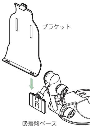
ブラケットを吸着盤ベースに『カチッ』というまで差し込み、調整ネジを仮締めしてください。
