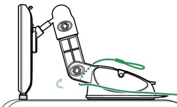
吸着盤ベースに、クリップと反対側のストラップコードをまわしてください。
