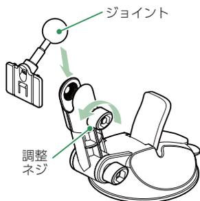
取り付けできるところまで、調整ネジを緩め、ジョイントを取り付けてください。
