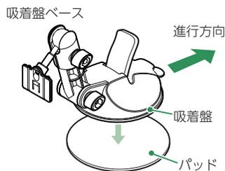
吸着盤ベースの保護紙をはがし、パッドに取り付けてください。吸着盤がパッドからはみ出さないように慎重に取り付けてください。
