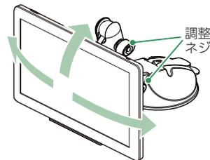
調整ネジを緩め、画面の角度を調整してから調整ネジを締めてください。
