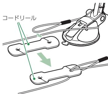
コードリールの片方の穴にストラップコードの輪とストラップコードを通してください。
