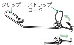
クリップをストラップコードの一方へ取り付けてください。
