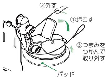
レバーを起こし、ストラップコードを外して吸着盤ベースを取り外してください。
