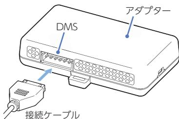
アダプターの[DMS]コネクタに接続ケーブルを接続します。
