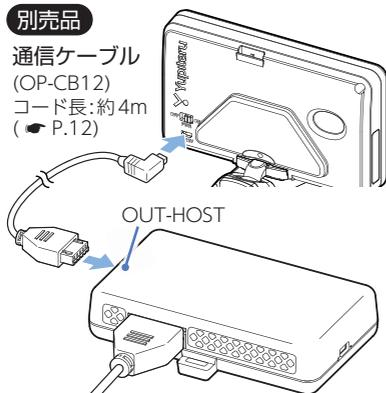
別売品の通信ケーブル(OP-CB12)をアダプターの[OUT-HOST]コネクタと、レーダー探知機のDCジャックに接続します。
