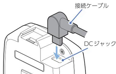
本機のDCジャックに接続ケーブルを接続します。
