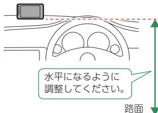
本体の背面を進行方向に向けて水平な路面と並行になるように取付けてください。
