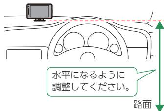
本体の背面を進行方向に向けて水平な路面と並行になるように取り付けてください。
