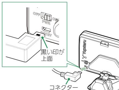
付属のシガープラグコードを本体のDCジャックと車両のシガーライターソケットに接続します。
