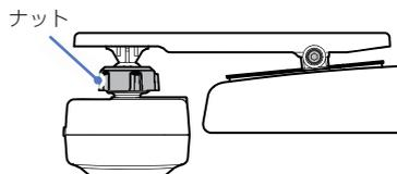
ナットを緩め、本機の向きを調整し、ナットを締めて固定します。
