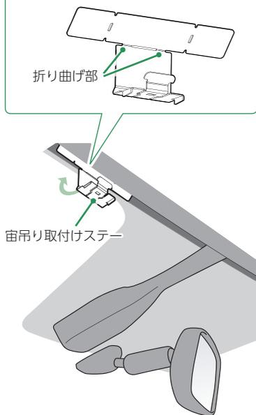
本体が路面に対して垂直になるようにステアを折り曲げて、角度を調整してください。
