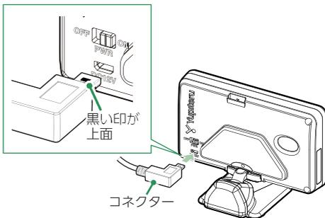
別売品のOBDIIアダプターを本体のDCジャックと車両のOBDIIコネクタに接続してください。
