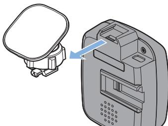
フロントガラス取付け用ジョイントレールをスライドさせ取り付けます。
