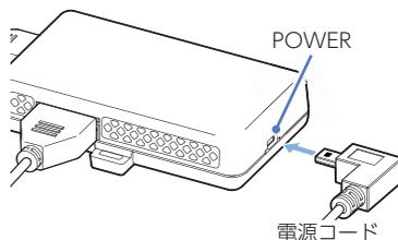
アダプターの[POWER]コネクタに、レーダー探知機に付属の電源コードまたは別売品のOBDIIアダプターを接続します。
