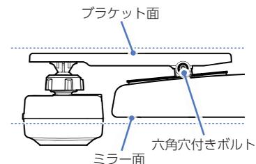
ルームミラーのミラー面と、ブラケットの面が平行になるように調整し、付属の六角レンチで六角穴つきボルトを締めて固定します。
