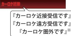
「無線自動車動態表示システム」のこと、警察の通信司令本部がパトカーなどの移動局の現在位置をリアルタイムで地図上に表示し、把握するためのシステムです。カーロケーターシステムを搭載した移動局は、GPSによる緯度・経度情報をデジタル化し、それを407.7MHz帯の周波数でデータ伝送しています。本機は、それを受信することにより、移動局が近くにいることを警報します。
