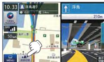
[道路切替]にタッチします。一般道の走行から、高速道の走行へと認識され、切り替わります。
