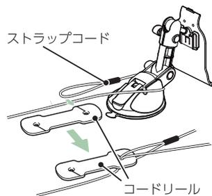
コードリールの片方の穴にストラップコードの輪とストラップコードを通します。
