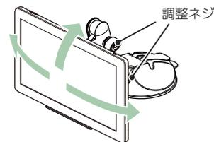
調整ネジを緩め、画面の角度を調整し、調整ネジを締めます。
