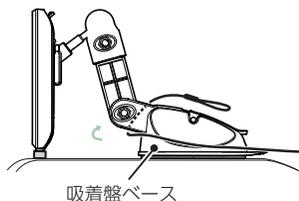
吸着盤ベースに、クリップと反対側のストラップコードをまわします。
