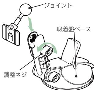
取り付けできるところまで、調整ネジを緩め、ジョイントを取り付けます。
