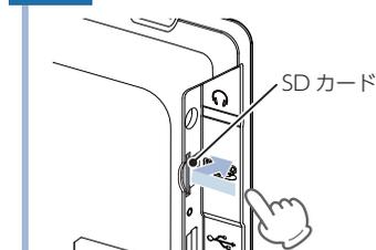
SDカードを押し込み、カードが少し飛び出してから引き抜きます。
