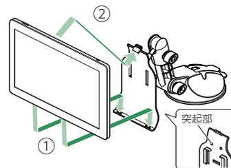
本体の溝をブラケット下部の爪に合わせてセットし、『カチッ』というまで、ブラケット背面の突起物を押します。
