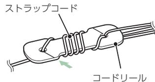
余ったストラップコードをコードリールに巻き付けて止め、たるまないように長さを調節します。
