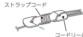
余ったストラップコードをコードリールに巻き付けて止め、たるまないように長さを調整する。
