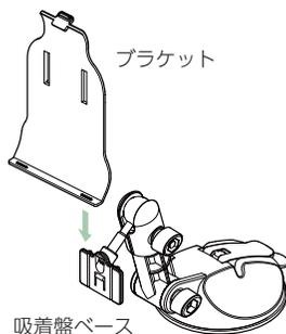
ブラケットを吸着盤ベースに『カチッ』というまで差し込み、調整ネジを仮締めします。
