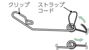
クリップをストラップコードの一方へ取り付けます。
