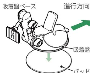
吸着盤ベースの保護紙をはがし、パッドに取り付けます。吸着盤がパッドからはみ出さないように慎重に取り付けます。
