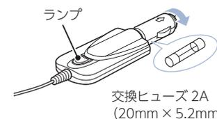
ヒューズを交換したあとは、シガープラグの先端を図の矢印と逆方向に回し、しっかりと締める
