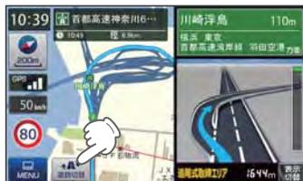
[道路切替]にタッチします。高速道の走行から、一般道の走行へと認識され、切り替わります。
