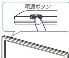
電源OFFは、電源ボタンを押すか、車両のエンジンをOFFします。
