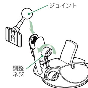
取り付けできるまで、調整ネジを緩め、ジョイントを取り付けてください。
