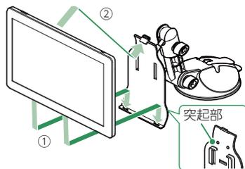
本体の溝をブラケット下部の爪に合わせてセットし、『カチッ』というまで、ブラケット背面の突起物を押してください。
