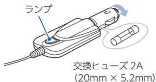
ヒューズを交換したあとは、シガープラグの先端を図の矢印と逆方向に回し、しっかりと締める
