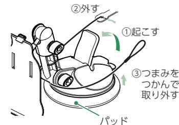
レバーを起こし、ストラップコードを外して吸着盤ベースを取り外してください。
