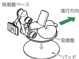
吸着盤ベースの保護紙をはがし、パッドに取り付けてください。吸着盤がパッドからはみ出さないように慎重に取り付けてください。
