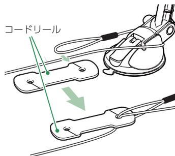
コードリールの片方の穴にストラップコードの輪とストラップコードを通してください。
