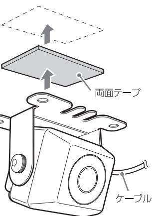
※両面テープでの取り付けが困難な場合などは、付属のカメラ取り付けビス(M3タッピングビス×14mm)を使用してください。
