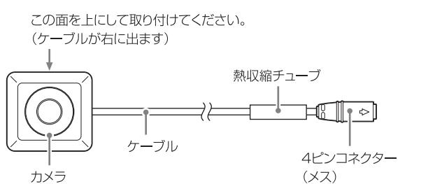
※熱伸縮チューブは、ガイドラインの[表示]・[非表示]選択後に加熱処理してください。(本書「接続先と構成図」を参照ください)
