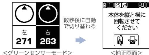
グリーンセンサーモードを数秒表示し、自動で補正画面を表示します。
