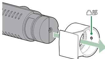
※ リアカメラ用ブラケットには凸部があり、無理に引き抜こうとすると破損の原因となります。必ず②の位置まで回してから取り外してください。
