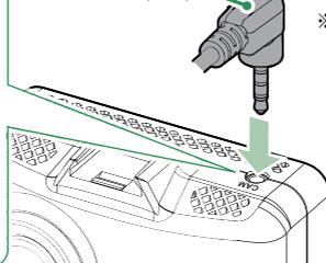
※ フロントカメラユニットにはプラグ(L型)をご使用ください。プラグ(ストレート型)を使用した場合、ケーブル接続時に負荷がかかり断線のおそれがあります。
