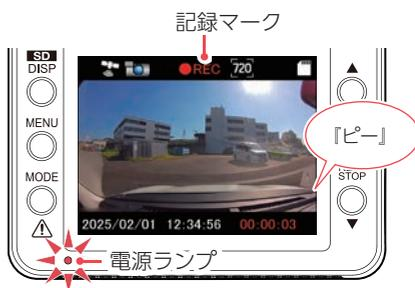
※付属品以外のSDカードを使用する場合、初回起動時に「SDカードを初期化してください」と表示します。数秒間無操作、またはOK(+ )ボタンを押してメッセージ表示を解除するとSD初期化画面( 3 )を表示します。
